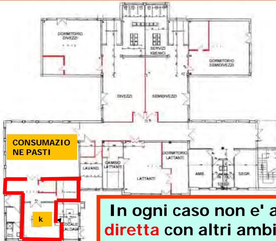
Gli impianti di cottura con **potenza inferiore a 35 kW** devono essere installati in locali caratterizzati da strutture, ed elementi di separazione/comunicazione con altri ambienti, aventi le caratteristiche R/REI 45-60-90 o 30.
