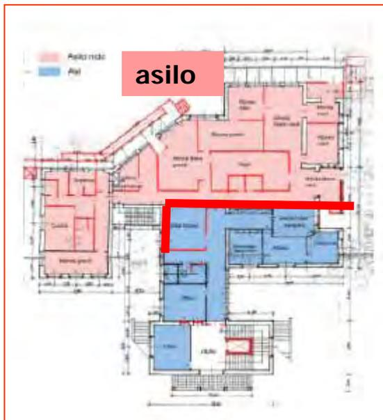
gli asili nido ubicati in edifici di tipo misto devono essere separati dalle altre parti dell' edificio con strutture di separazione aventi caratteristiche di **resistenza al fuoco** non inferiori a :
